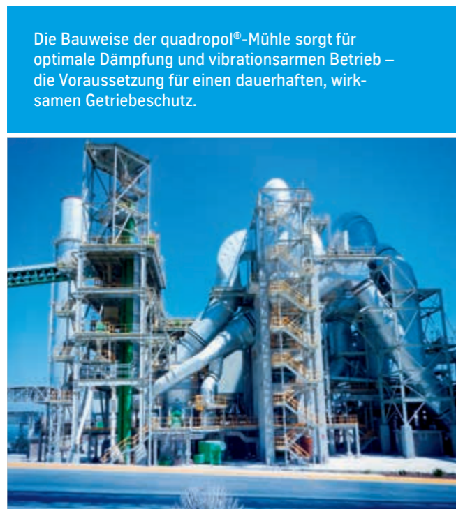
QMR 2 in Mexiko: offenes Anlagenkonzept mit einer QMR 2 43/21.
