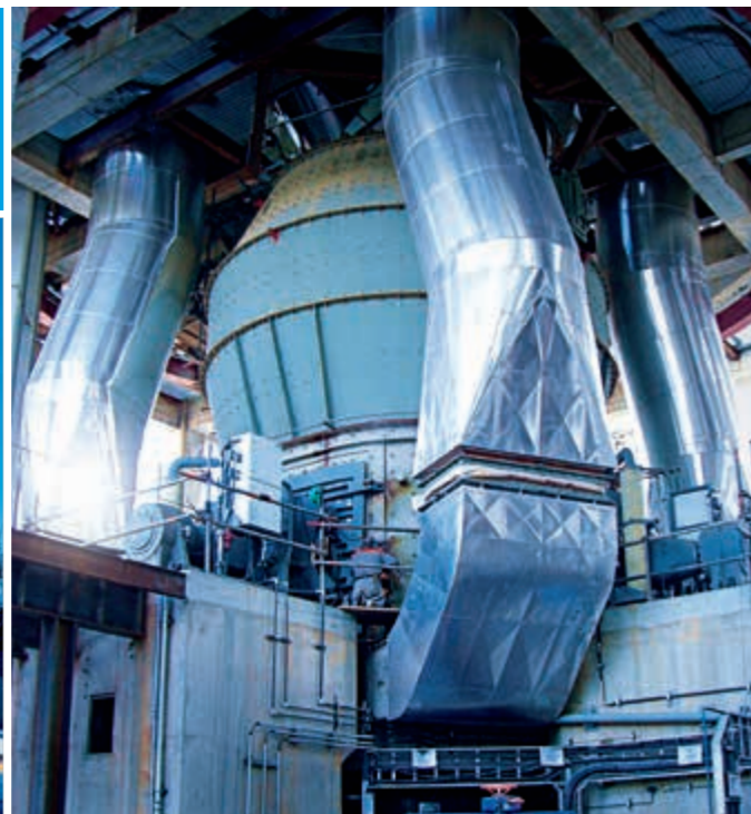
QMR 2 43/21 in Brasilien: Sie erreicht Feinheiten von 8 % R 90 µm.
