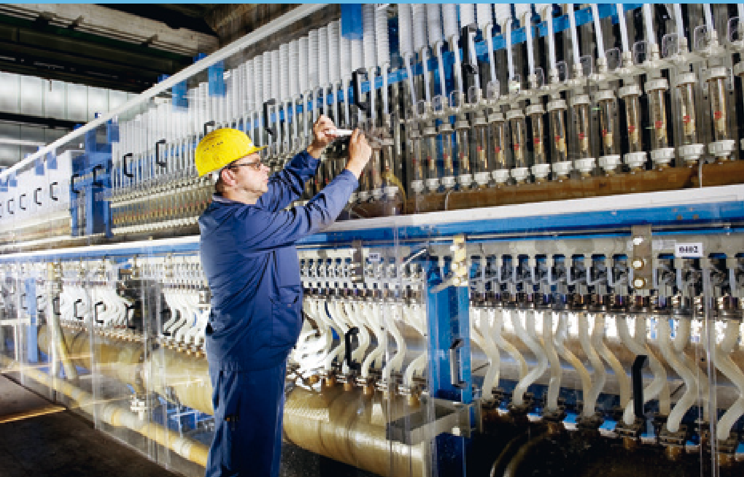
Innovation für mehr Effizienz: Sauerstoffverzehrkathoden für die Produktion von Chlor und Natronlauge.
