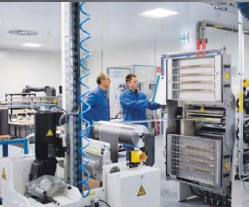
Unter Druck: Eine Kalandriermaschine verdichtet die Batterie-Elektroden – ein wichtiger Bearbeitungsschritt auf dem Weg zum Batteriesystem.
