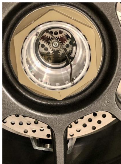
Abbildung 5/6: Antriebsstrang, in der 13 Zoll-Magnesiumfelge verbaut
