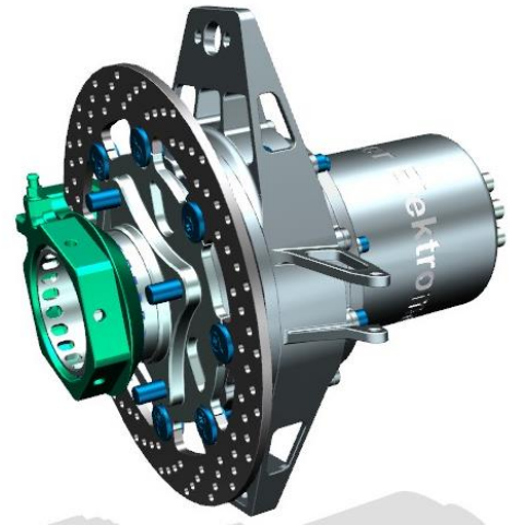
Abbildung 4: Gesamte Antriebseinheit bestehend aus v.l.n.r Radnabe, Bremsscheibe, Radträger, Planetengetriebe Elektromotor.
