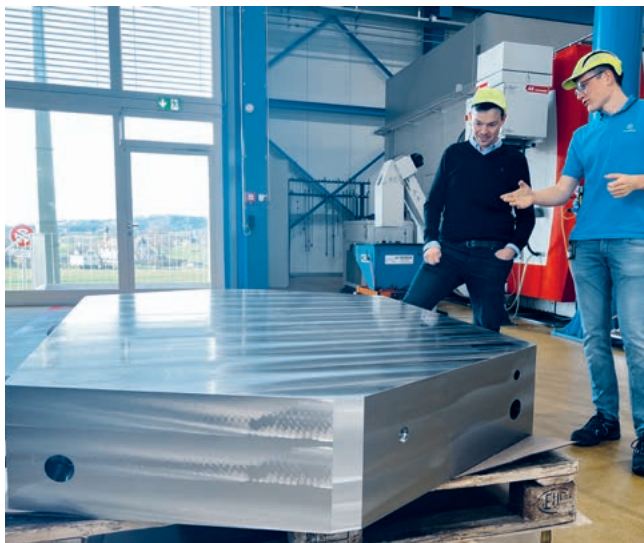
Pumpendeckel mit Sonder-US-Prüfung. Vorbearbeitet durch thyssenkrupp.
