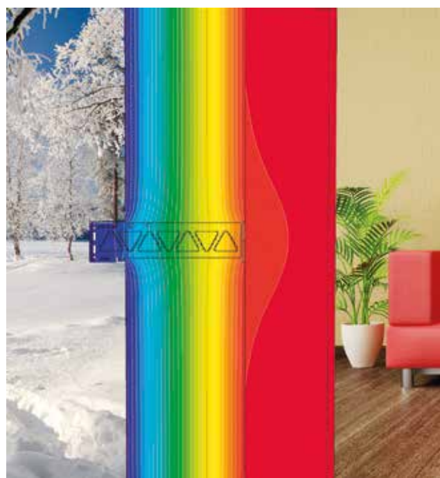
Image 2 - Equerre EJOT CROSSFIX® : pont thermique minimisé
