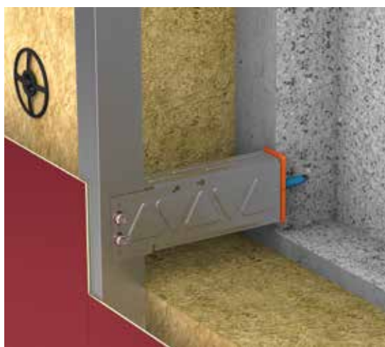
Point coulissant : Vissage dans un trou oblong
