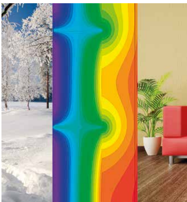
Image 1 - Equerre en aluminium : pont thermique important
