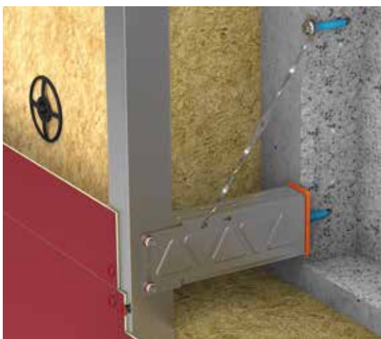
Point fixe : Vissage dans le trou et possibilité d'utiliser une jambe de force pour une meilleure résistance à la charge
