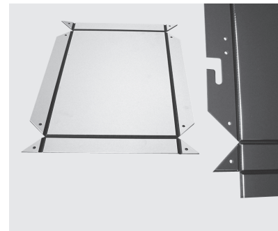
Poinçonnage de cassettes
