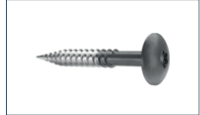
Swisspearl Fassadenschraube 4,5 x 41 mm V2A / V4A für sichtbare Befestigung auf Holz-UK. In allen Farbtönen erhältlich
