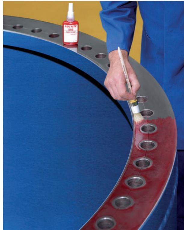
Bild 16: Auftragen von Loctite
