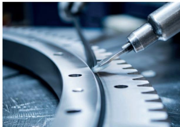
Bild 48: Dichtungsaustausch
