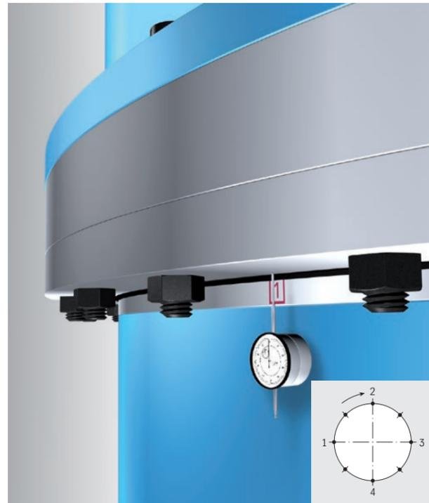
Bild 34: Prinzipieller Aufbau der Kippspielmessung
