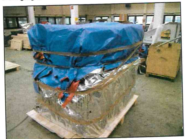
Abdeckung mit Gewebeplane
