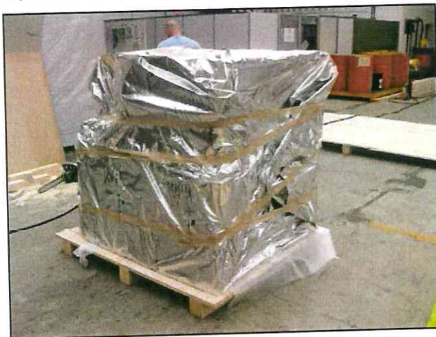
Aufsetzen der Aluminiumverbund-Folienhaube, Verschweißen, Absaugen der Luft und Verschließen der Absaugöffnung
