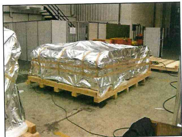
Aufsetzen der Aluminiumverbund-Folienhaube, Verschweißen, Absaugen der Luft und verschließen der Absaugöffnung
