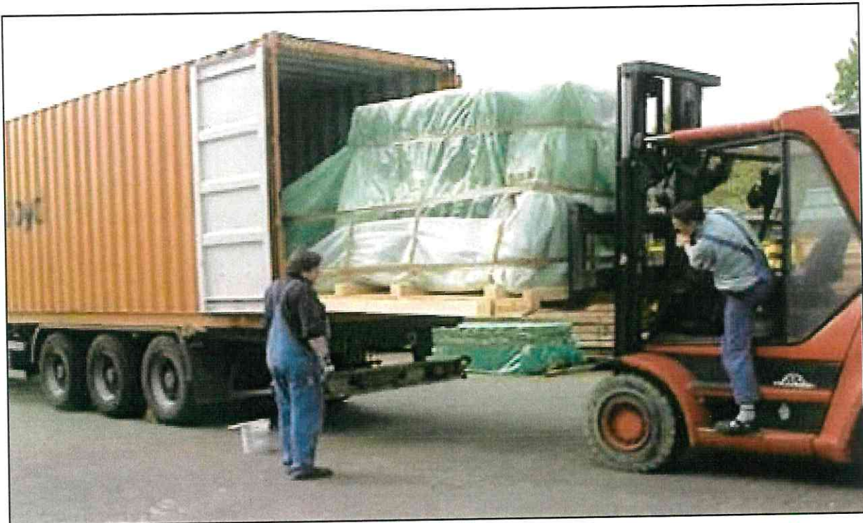
Zur Containerverladung Stapler mit der nötigen Hubkraft und langen Gabeln verwenden
