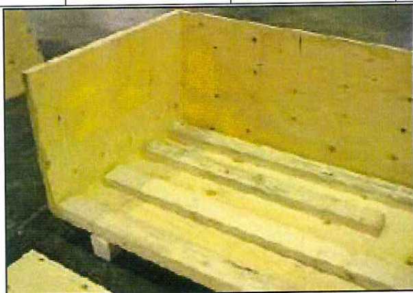
Bei Packstücken > 500 kg den Boden mit Hölzern 5 x 10 cm verstärken
