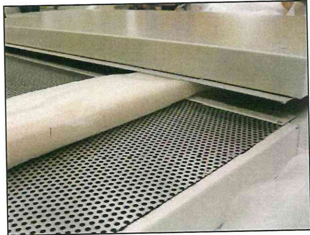
Soweit erforderlich separieren der Teile durch abgepolsterte Holzleiste
