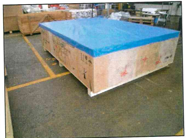
Montage der Kistenhaube, Anbringung der Markierung und einer Kopfhaube aus Gewebeplane
