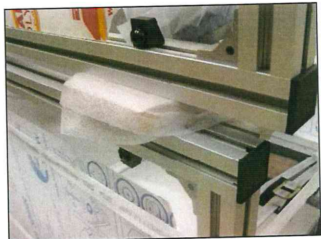
Soweit erforderlich separieren der Teile durch gepolsterte Holzleisten
