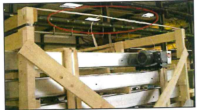
Um ein Durchhängen der VCI-Folie zu verhindern, wird ein Band angebracht
