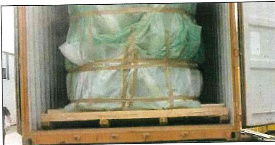
Die letzte Plattform braucht keine Stahlschleife, da der Stapler unter die Plattform fassen kann.
