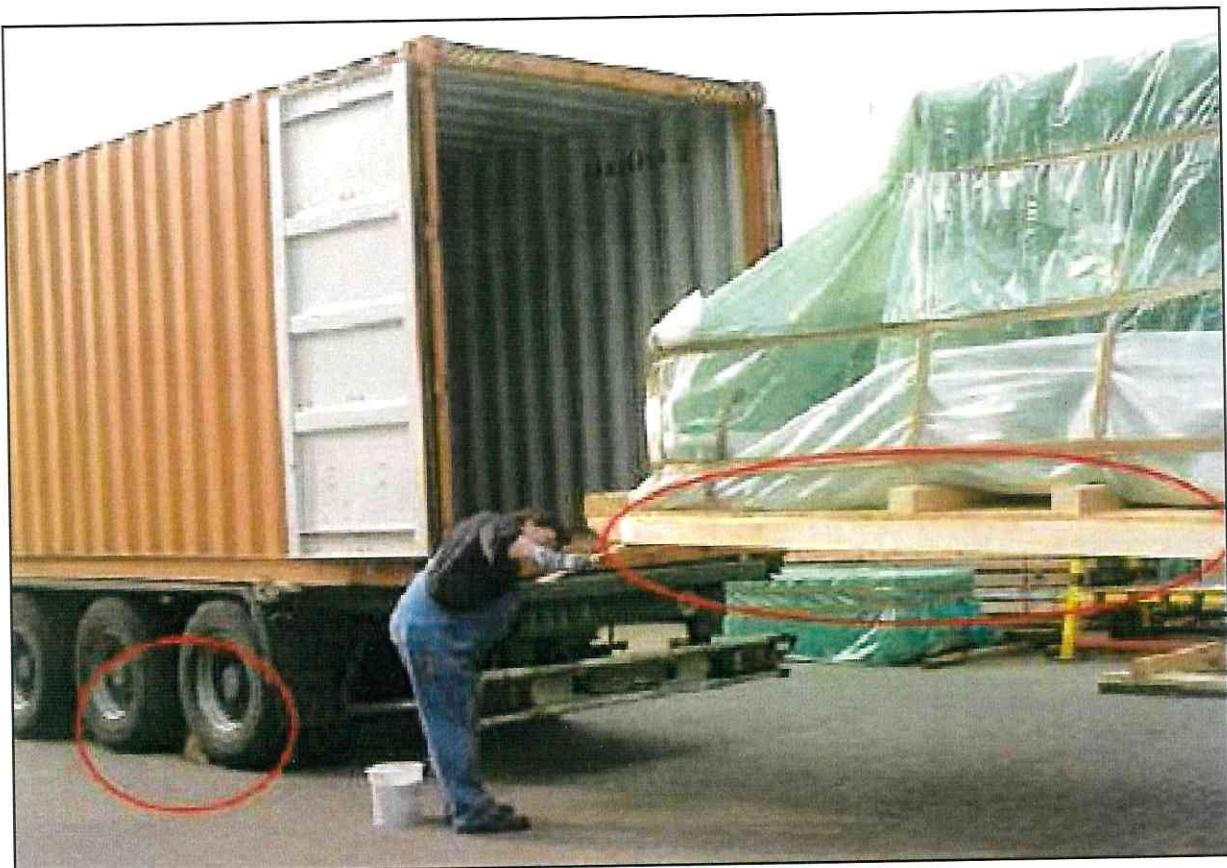
Für die Abstützung im Container seitlich je eine Kufe vorsehen (Schmierseife erhöht die Gleitfähigkeit der Plattform)
