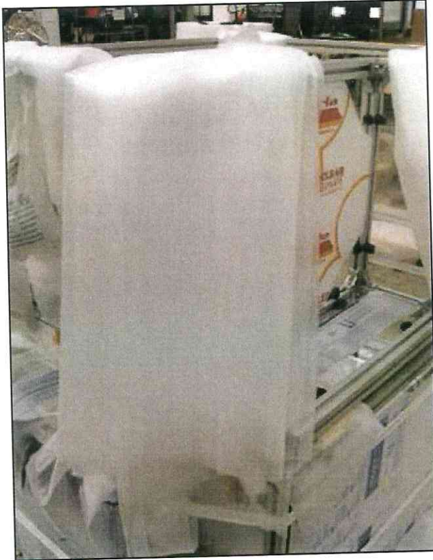
Abpolstern von Ecken und exponierten Teilen mit Schaumfolie
