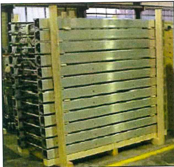
Die Collis zum Verpacken der FR-Bahnen, Transportsystemständer, Schutzgitter und anderer sperriger Güter sind Kantholzgestelle.
