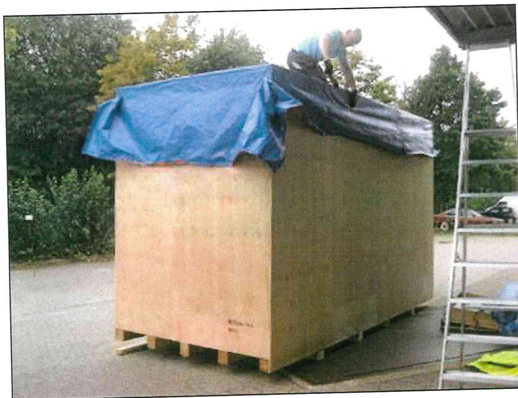
Montage der Kistenhaube, Anbringung Markierung (Schwerpunkt außermittig!), einer Kopfhaube aus Gewebeplane und Kufen-/Kantenschutzwinkel
