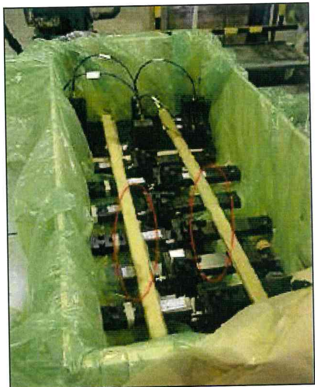
Stahlseile besonders sichern.
