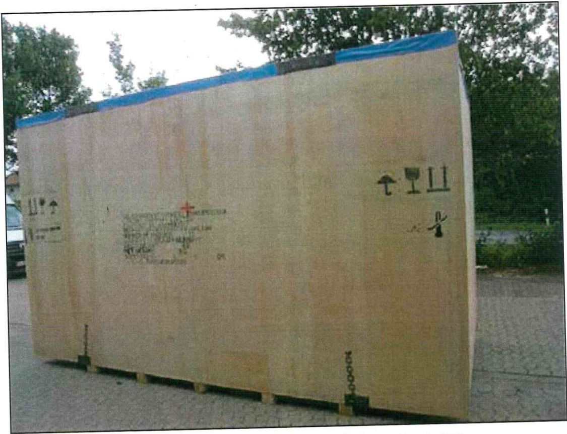
Montage der Kistenhaube, Anbringen der Markierung und einer Kopfhaube aus Gewebeplane
