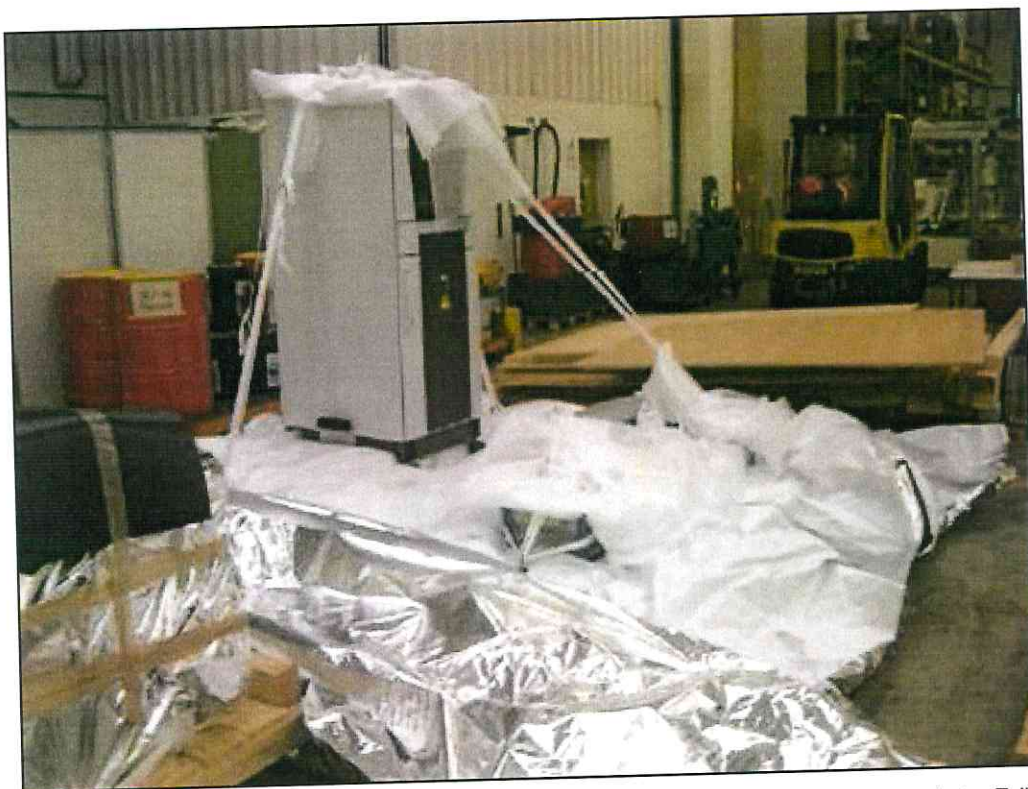
Fixieren durch Polyester-Spannband (Cordstrap 200 dN) und Abpolstern von Ecken und exponierten Teilen mit Schaumfolie
