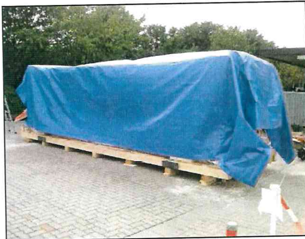
Überlegen einer durchgängigen Gewebeplane
