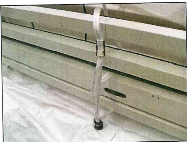
Fixieren durch Polyester-Spannband (Cordstrap 2000 dN)
