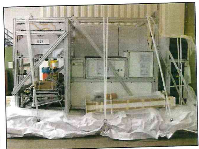
Fixierung durch Polyester-Spannband (Cordstrap 2000 dN)
