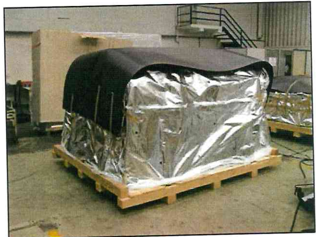
Abdeckung mit Akyluxplatten
