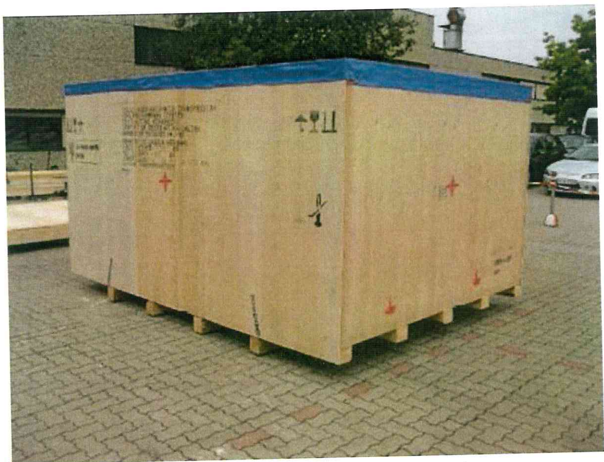
Montage der Kistenhaube, Anbringung der Markierung und einer Kopphaube aus Gewebeplan
