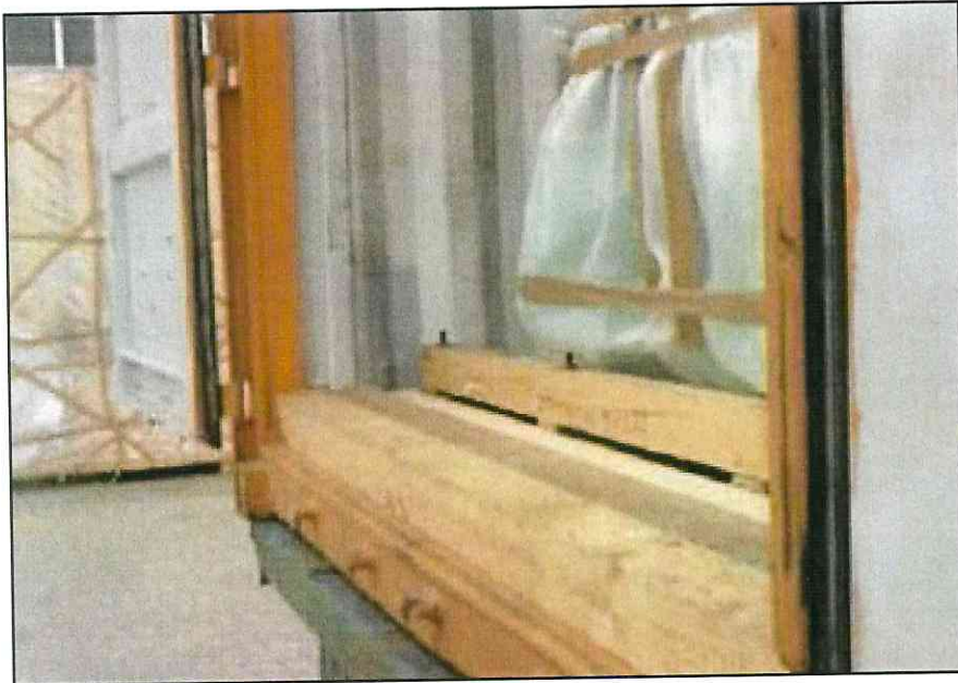
Als Abschluss einen Querbalken einlegen, um die Ladung zu sichern.
