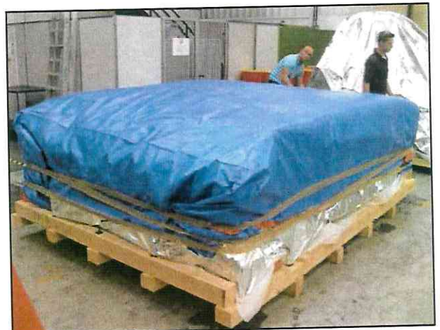
Abdeckung mit Gewebeplane
