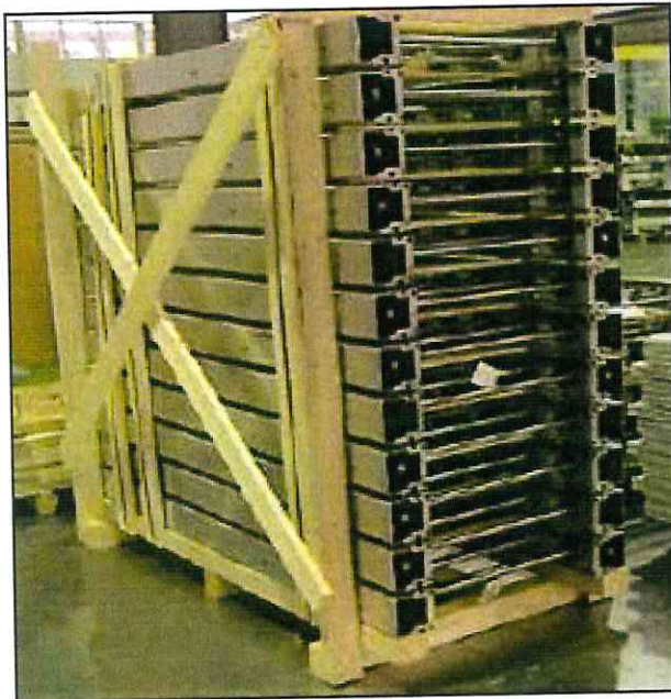
Mit Streben und Stahlbändern wird das Packgut gesichert.
