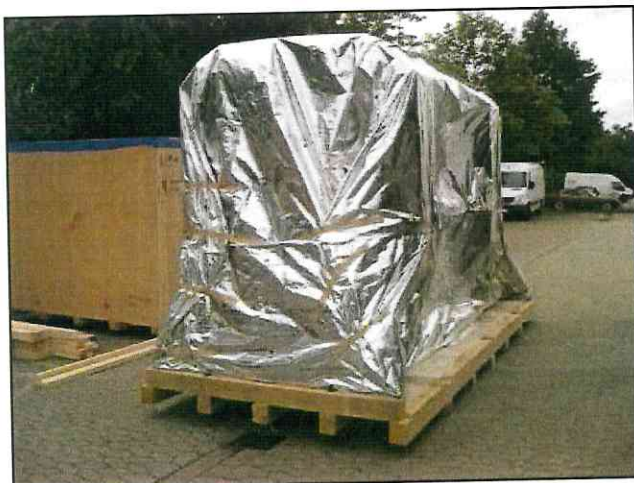
Aufsetzen der Alimiumverbund-Folienhaube, Verschweißen, Absaugen der Luft und Verschließen der Absaugöffnung
