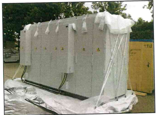
Abpolstern von Ecken und exponierten Teilen mit Schaumfolie und Anbringung von Trockenmittelbeuteln (mind. 20 kg)
