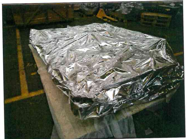
Anbringung von Trockenmittelbeuteln (mind. 8 kg) sowie Aufsetzen der Aluminiumverbund-Folienhaube, Verschweißen, Absaugen der Luft und Verschließen der Absaugöffnung
