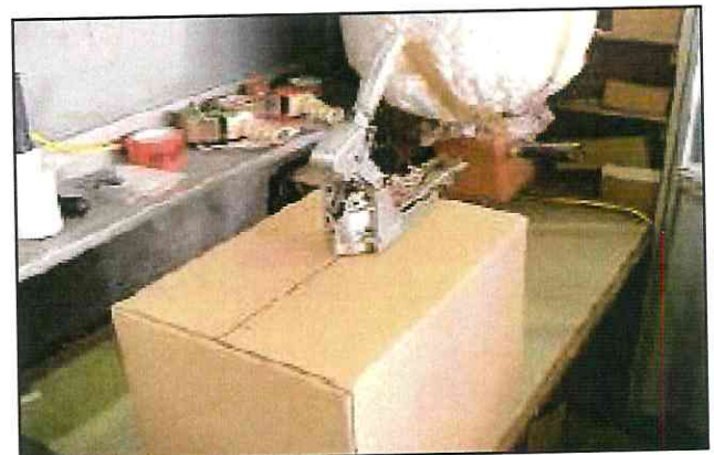
Bei höherem Gewicht auch den Deckel klammern!
