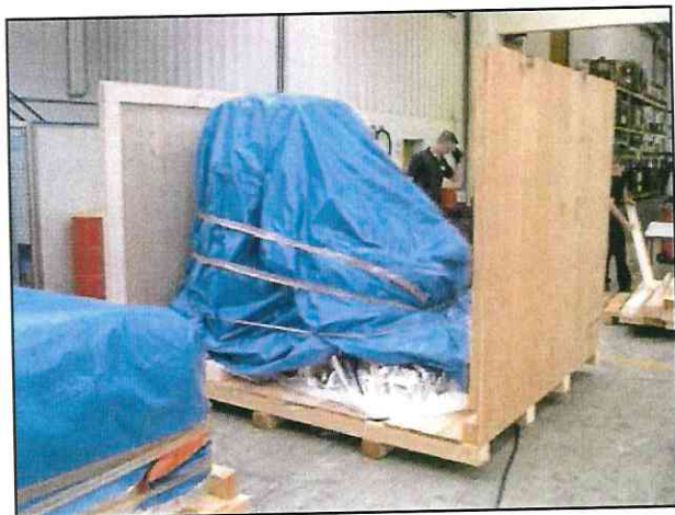
Abdeckung mit Gewebeplane
