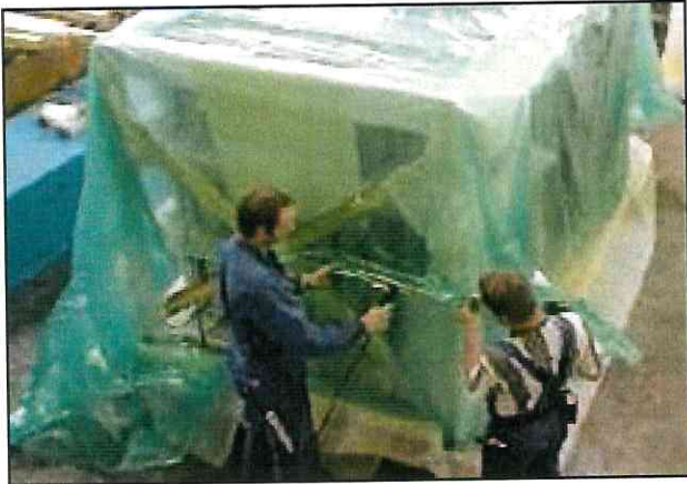
Die VCI Folie wird verschweißt. (Eine Öffnung für das Absaugen der Luft freilassen!)
