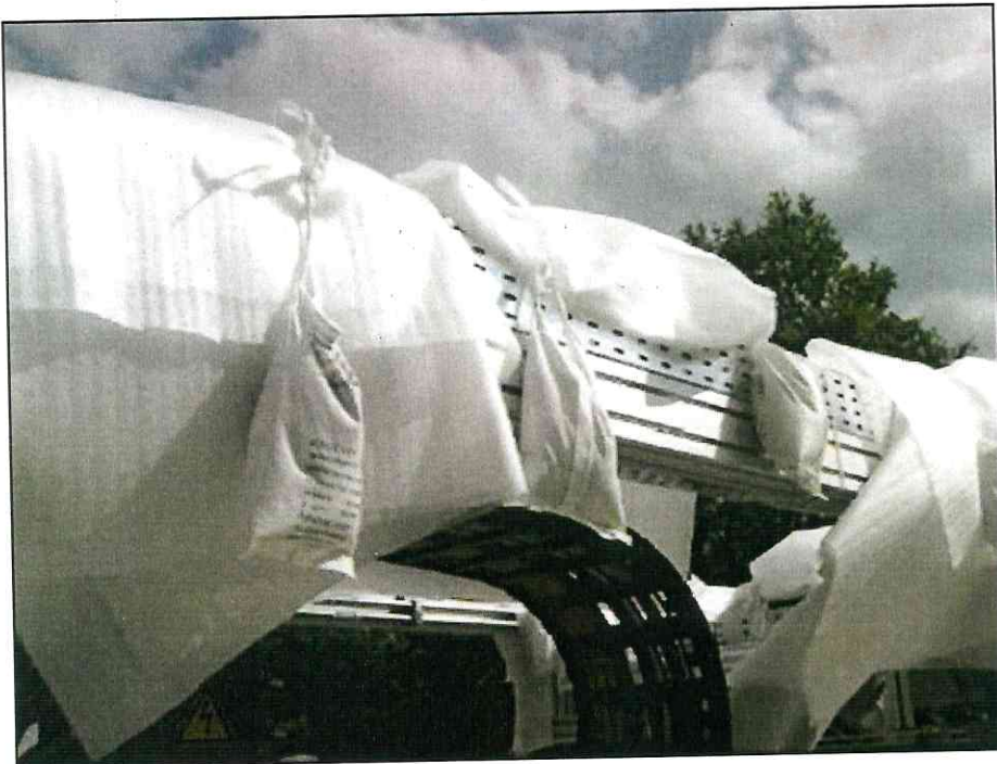
Anbringung von Trockenmittelbeuteln (mind. 24 kg)
