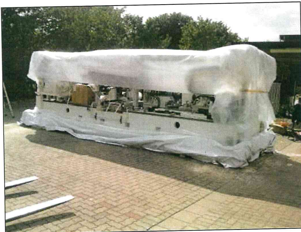
Überlegen einer durchgängigen PE-Folie
