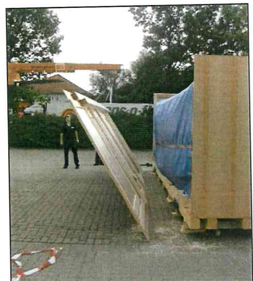
Anbringen der Kistenwände
