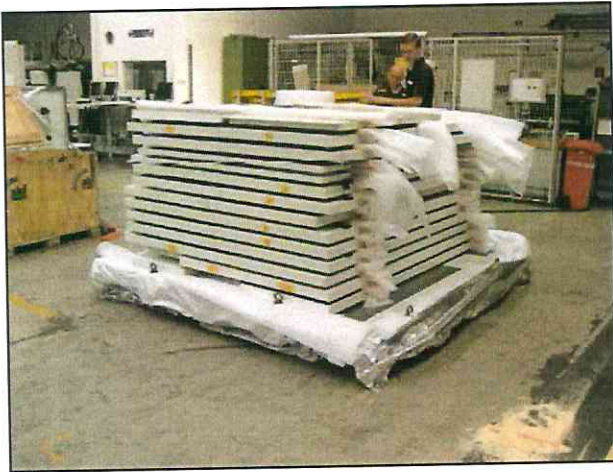
Auslegen des Bodens mit Schaum- und Aluminiumverbund-Folie und Aufstapeln des Packgutes
