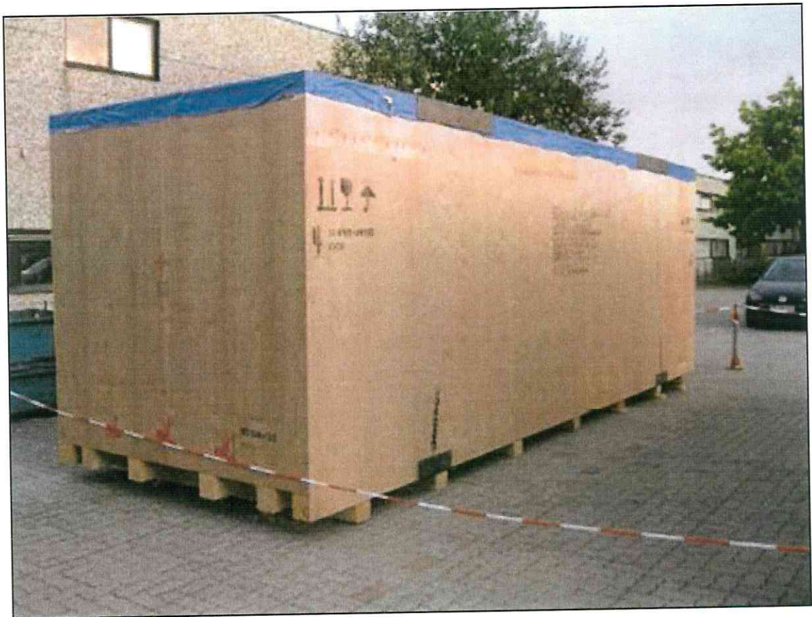
Anbringen der Kufen- und Kantenschutzwinkel sowie Kennzeichnung der Kiste
