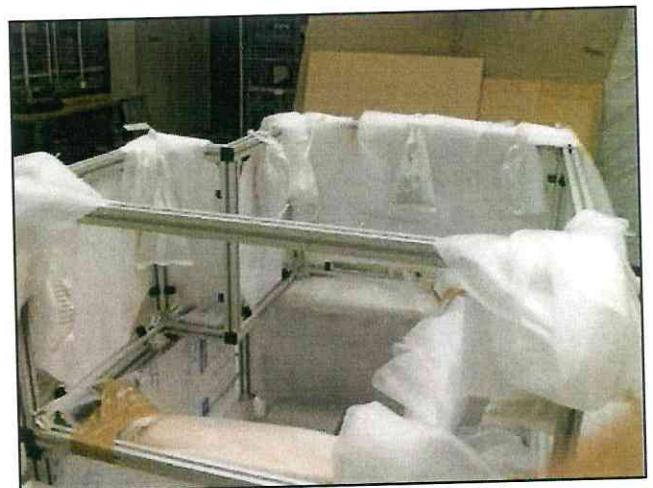
Anbringung von Trockenmittelbeuteln (mind. 6 kg)
