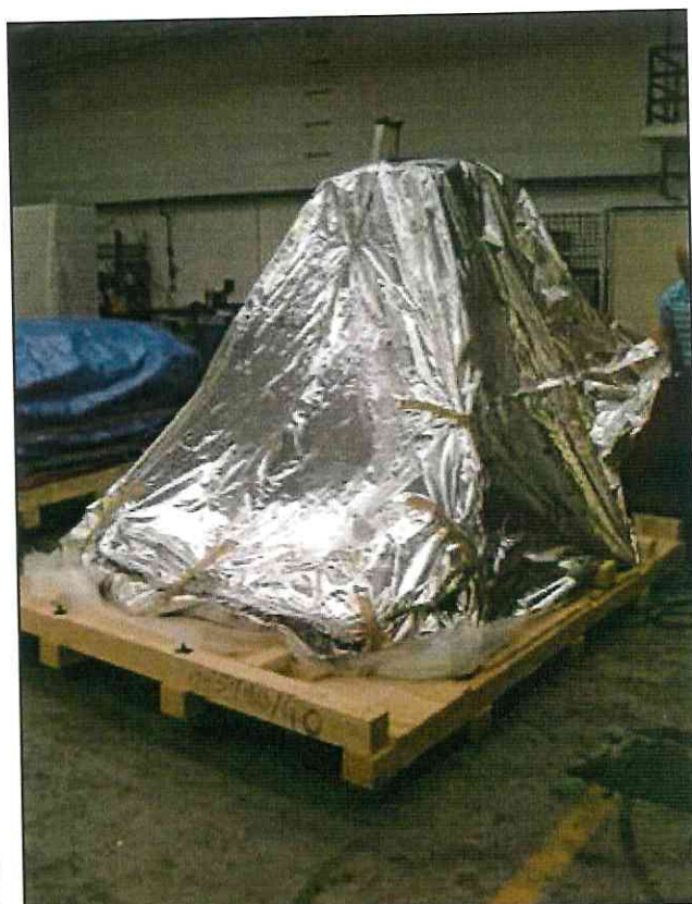
Aufsetzen der Aluminiumverbund-Folienhaube, Verschweißen, Absaugen der Luft und Verschließen der Absaugöffnung
