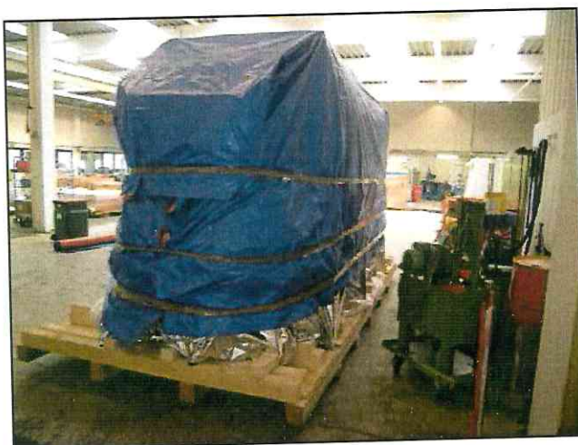
Abdeckung mit Gewebeplane
