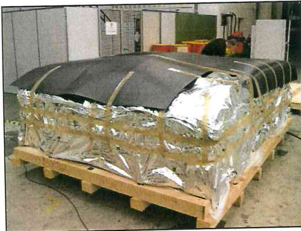
Abdeckung mit Akyluxplatten
