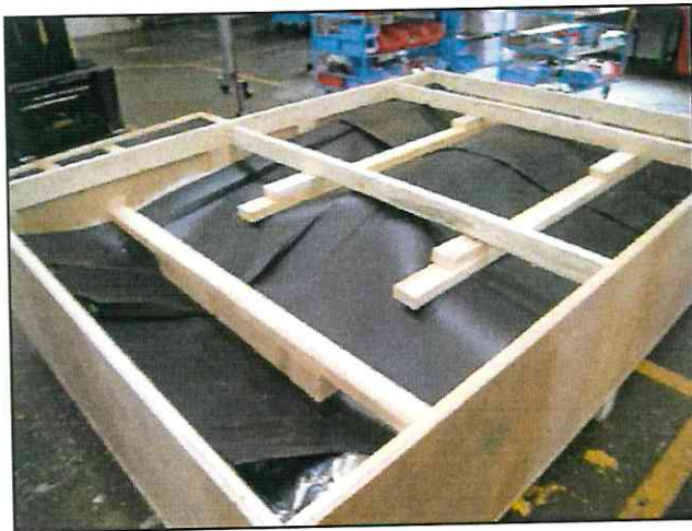
Auflegen von Akyluxplatten, Montage der Seitenwände und Einbringen von Druckhölzern zur Fixierung des Packgutes
