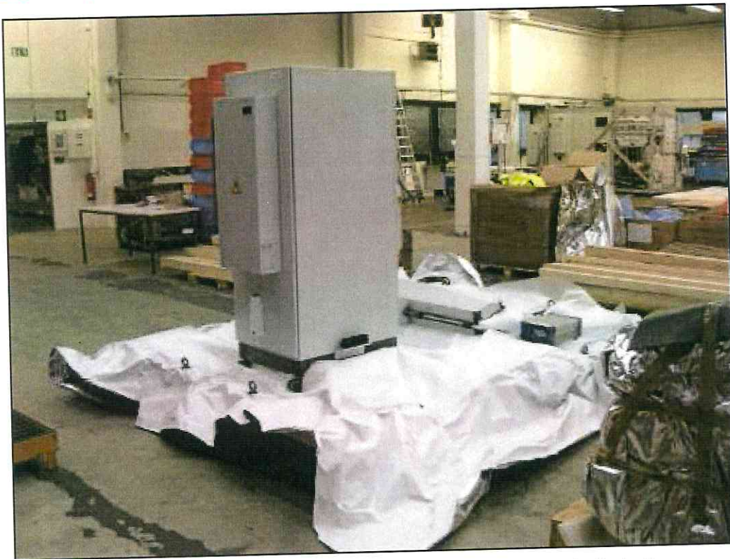
Auslegen Des Bodens mit Schaum- und Aluminiumverbund-Folie und Aufstellen des Packguts
