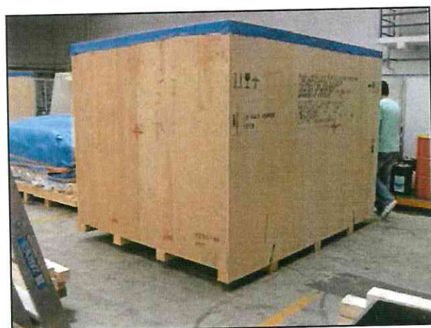
Montage der Kistenhaube, Anbringung der Markierung und einer Kopfhaube aus Gewebeplane
