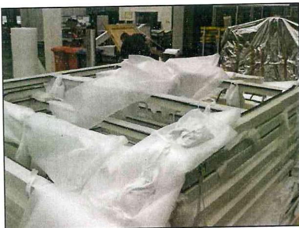
Anbringung von Trockenmittelbeutel (mind. 12 kg)
