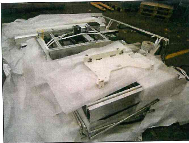
Auslegen des Bodens mit Schaumfolie, Aluminiumverbund-Folie und Schaumfolie sowie Platzierung und Fixierung des Packgutes, Abpolstern von Ecken und exponierten Teilen mit Schaumfolie
