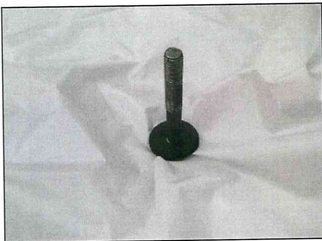
Aufsetzen von Gummidichtungen auf die Bolzen
