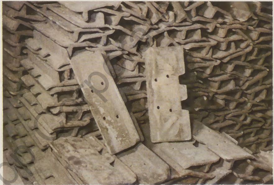
Gesenk-geschmiedete Bodenplatten für Raupe-Ketten-Fahrzeuge
