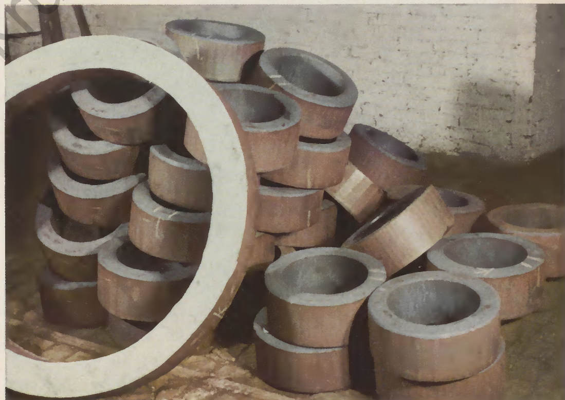
Freiform-geschmiedete nahtlose Ringe nach der Kontrolle
