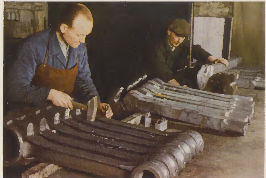
Kontrolle von gesenk-geschmiedeten Pleuelstangen und Zughaken
