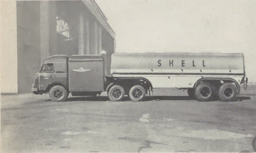
HS 3-125 als Sattelzugmaschine mit Tankauflieger für 26 000 l Inhalt für den Flugfeldverkehr. Hinter dem Fahrerhaus großer Armaturenschrank.
