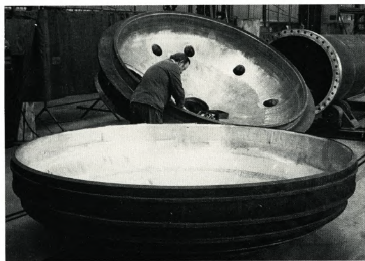
Titanplattierte Behälterböden während der Fertigbearbeitung bei der Firma Apparatebau Carl Canzler.
