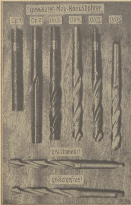
Abbildung 3 Werdegang des gewalzten Bohrers
