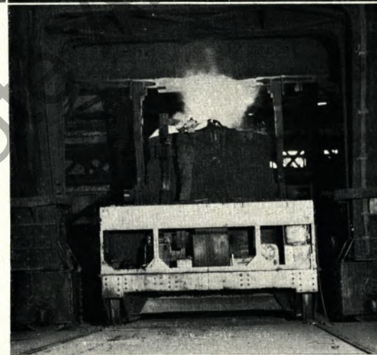
Eine 160-Tonnen-Pfanne im SM-Werk I wird abgegossen. — Rechts: Im SM-Werk II werden Schmiedeblocke gegossen. — Bild Mitte: Der Stahlübergabewagen transportiert die Pfanne in die Gießhalle von SM II
