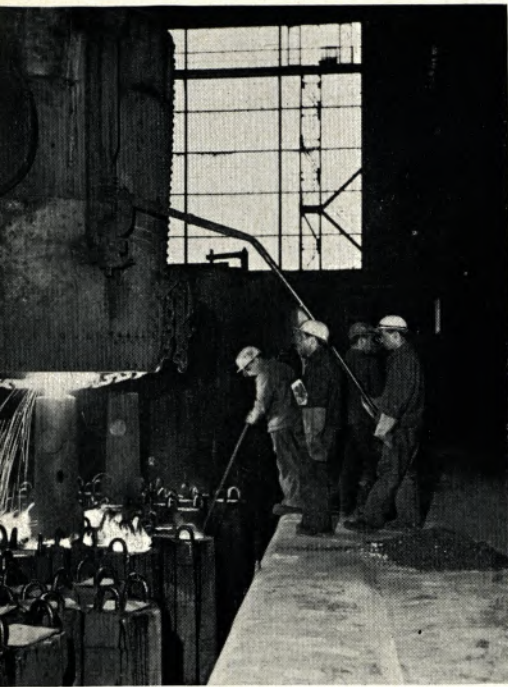
↙ Für die Rohrfertigung werden runde Blöcke benötigt. Der Stahl ergießt sich aus der Pfanne in den Eingußtrichter und füllt die Kokillen gleichzeitig von unten
