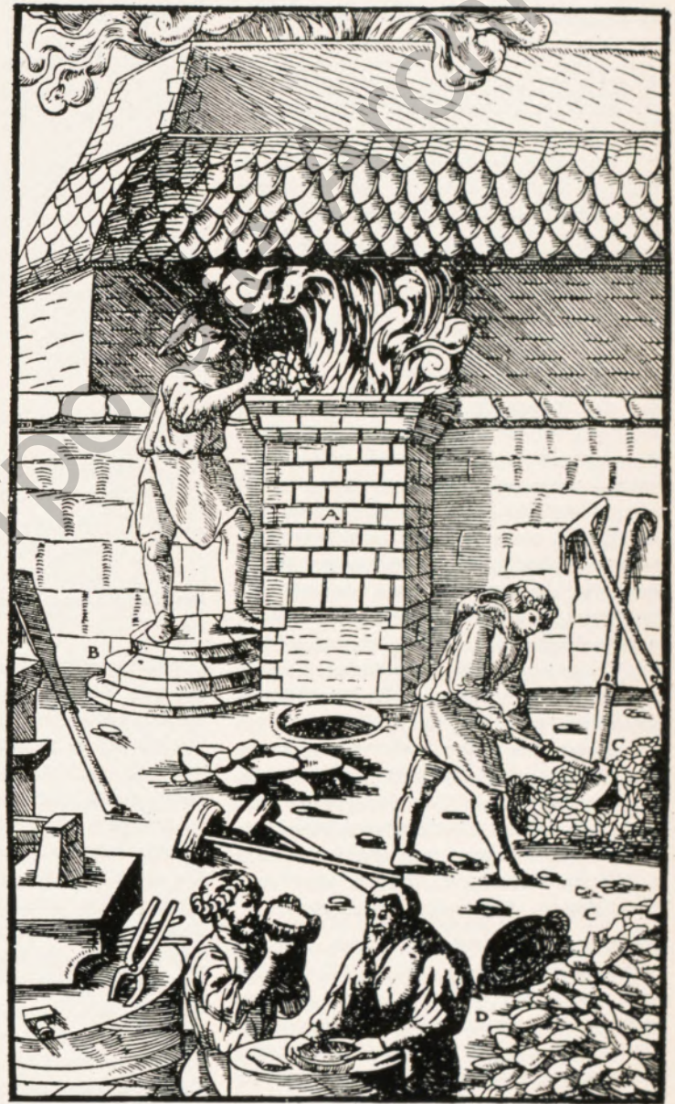
Stückofen (Aus Agricola: De re metallica)
