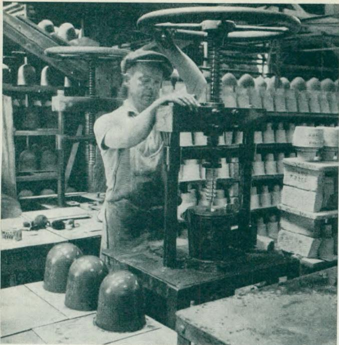
... Der die unter Handspindelpresse (oben) zu laufend benötigten Steine gepreßt bzw. mit Hilfe von Druckluft getampft werden (unten).
