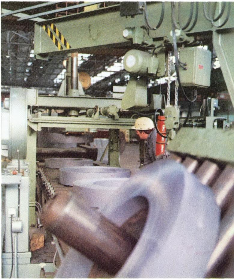
tigung von Qualitätsblechen ausgebaut wurde. Mit dieser Anlage wurde dann die Produktion von kaltgewalztem, kornorientierten Elektrobänd aufgenommen.
